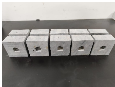
(b) 制备好的千枚岩开孔试样
